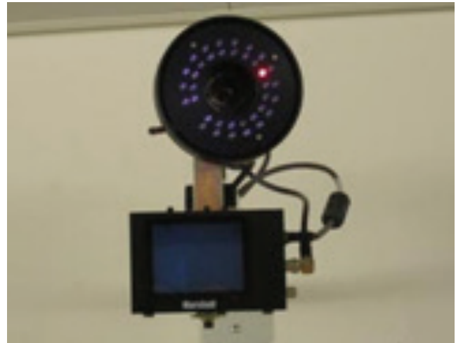
Die im Bestrahlungsraum installierte Infrarot-Kamera mit entsprechenden Lichtquellen verfolgt die Bewegung des Markerblockes auf der Patientin. Dadurch wird der Atemzyklus festgehalten
